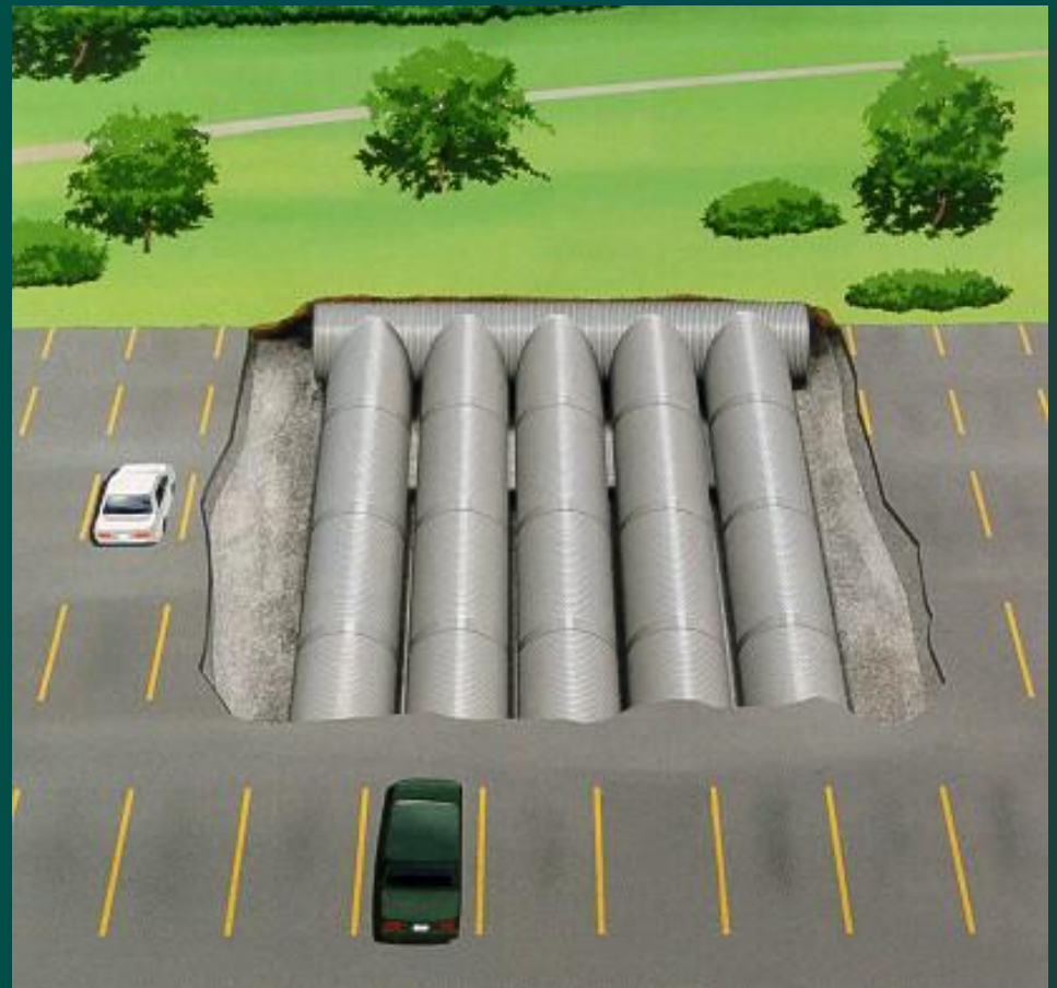
Reservatório de detenção
